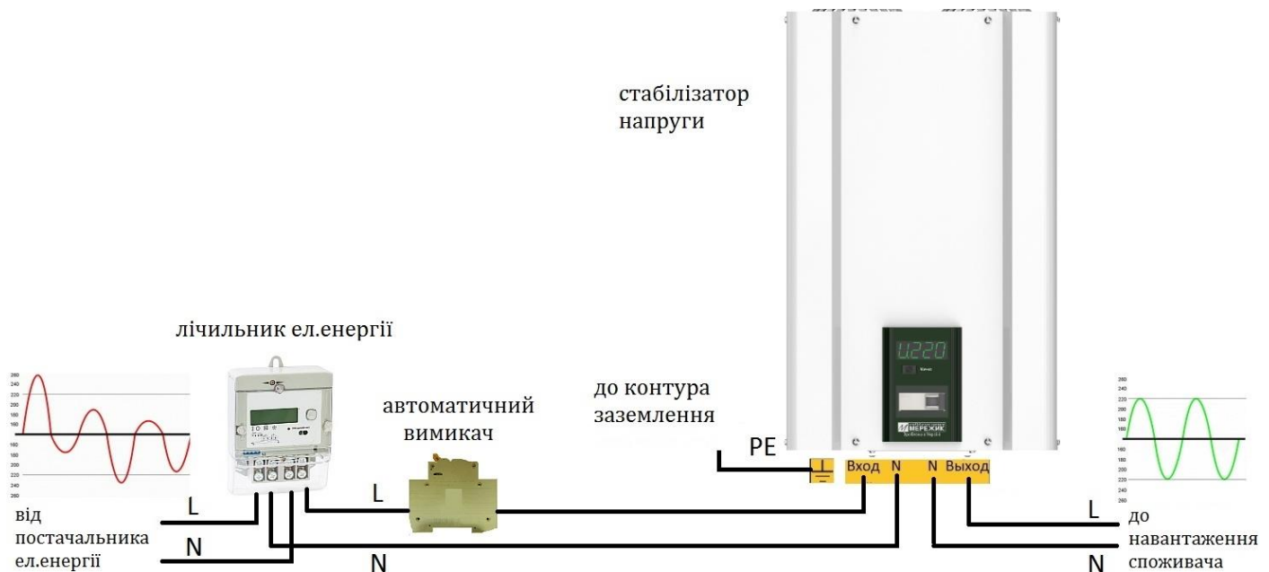
Рисунок 6. Схема підключення стабілізатора до однофазної мережі
